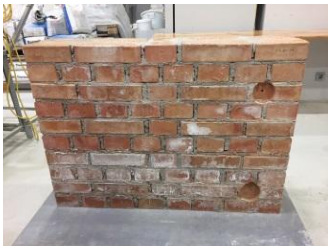
Z vlago in solmi obremenjen zid
